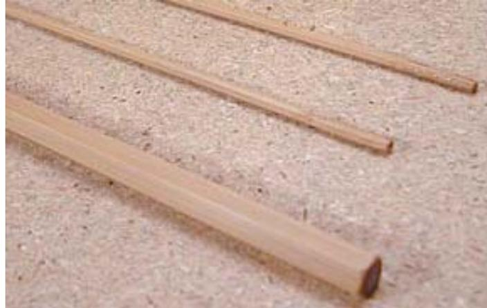
Durch eventuell auftretende Spannungen zwischen den verklebten Spleißen können leichte Verformungen im Blank entstanden sein, welche vorsichtig mit Wärme gerichtet werden. Nun werden die Verbindungshülsen aus bestem Nickelsilber montiert.
