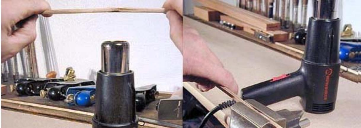
Bei gründlicher Arbeit ist ein Rohling entstanden, dessen Kraftfasern auf der ganzen Länge durchgehend erhalten bleiben, was für die optimale Funktion und Langlebigkeit der späteren Rute ausgesprochen wichtig ist.
