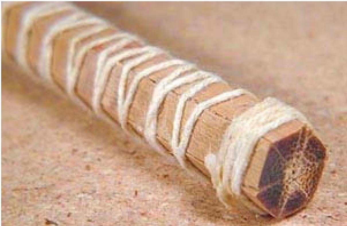
Die gebundenen Strips; auf diesem Foto erkennt man sehr gut die Lage, den Verlauf und die Anordnung der dunklen Kraftfasern in den einzelnen Segmenten.
