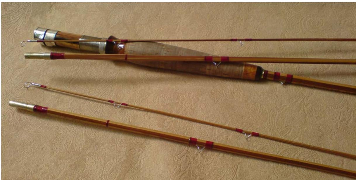
*The Hollow Helix* in 7' 6'' (229 cm), AFTMA 5, Nr. B8-756-3; Rollenhalter Cocobolo/Olivenholz-Nickelsilber; gut erkennbar sind auf dem unteren Foto die gewundenen Spleiße an den oberen beiden Segmenten
