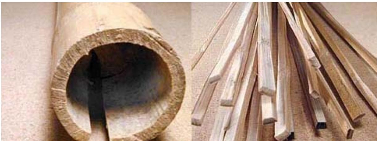
Die beiden Hälften werden nun in einzelne Streifen so aufgespleißt, dass die durchgehenden Kraftfasern der Länge nach erhalten bleiben.
